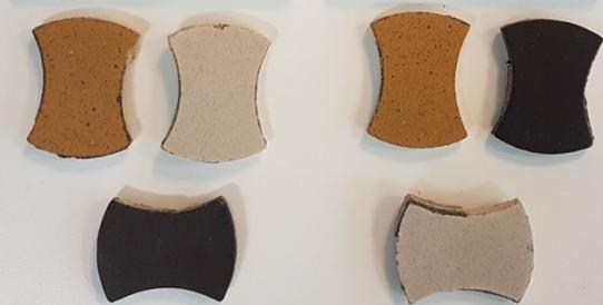
Nach der Freigabe werden kleine Mosaiksteine aus Gießkeramik gefertigt und anschließend die keramische Oberfläche reproduziert anhand ausgewählter Glasur- und Farbpigmente. Die Fliesen werden erneut gebrannt.
