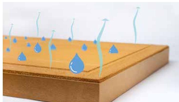
Lehmputz nimmt erhöhte Luftfeuchtigkeit auf und verdunstet sie in den Raum zurück.
