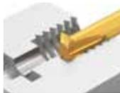
Schaffräser aus Feinstkornhartmetall für die Zirkularfräsbearbeitung von Bohrungen ab  $\varnothing$  1,4 mm. Verfügbar als drei- und z.T. vierschneidige Variante. Hohe Nuttiefen, sowie hohe Gewindetiefen bei reduziertem Schnittdruck, sind mit diesem Werkzeugsystem möglich.
