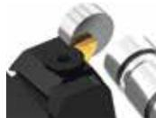
Werkzeugsystem bestehend aus dreischneidiger Hartmetall-Wendeschneidplatte und einer Auswahl an Stahl-Trägerwerkzeugen. Mögliche Stechtiefen bis 6,0 mm bzw. je nach Anwendung bis zu 8,0 mm bei der Außenbearbeitung. Verschiedene geschliffene Spanformgeometrien verfügbar.
