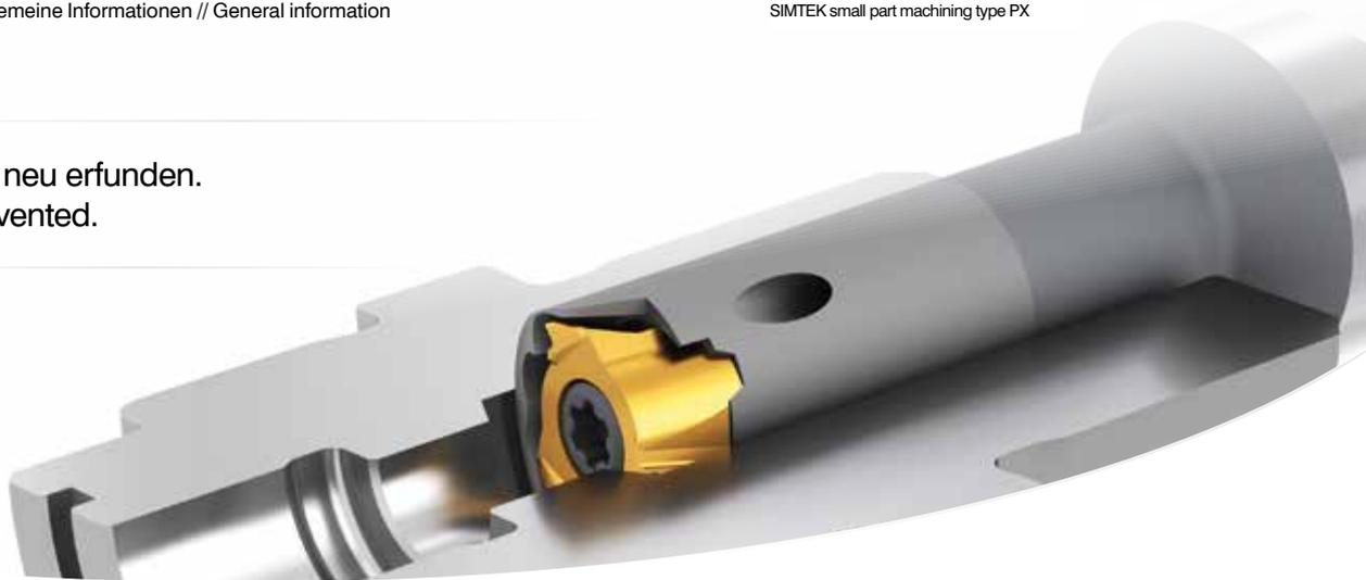
Innovatives Werkzeugssystem für das Ausdrehen von Bohrungen ab  $\varnothing$  7,8 mm bestehend aus dreischneidigen Wendeschneidplatten mit verschiedenen Schneidengeometrien sowie schwingungsgedämpften Hartmetallschäften oder Stahlschäften mit innerer Kühlmittelzufuhr.
