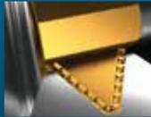
SIMTEK Präzisionswerkzeuge stehen für hohe Leistungsfähigkeit und Prozesssicherheit. Mittels 3D-gelaserten Spanformgeometrien steigern wir diese Leistungsfähigkeit und Prozesssicherheit selbst unter schwierigsten Bearbeitungsbedingungen. Anwendungsspezifisch erweitern wir diese um 3D-konturierte, gelaserte Spanformgeometrien. Diese Geometrien erfüllen unterschiedlichste Zielsetzungen, aber vor allem zwei: **Ihre Kosten senken und Ihre Produktivität steigern.**
