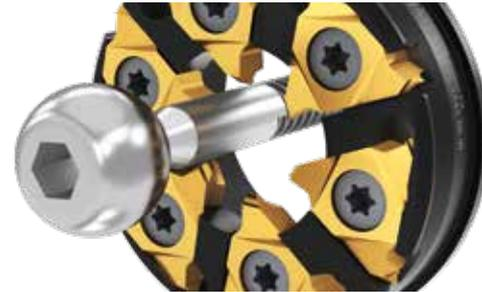
Werkzeuggruppe für das Gewindewirbeln in der Medizintechnik, der allgemeinen Serienteilfertigung und bei schwer spanbaren Materialien. System bestehend aus hochpräzisen, dreischneidigen Hartmetall-Wendeschneidplatten mit ausgesuchten Beschichtungen und passenden Wirbelringen für verschiedene Maschinen und Aggregate.
