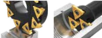
System bestehend aus Scheibenfräser, Messerkopf oder Schaftfräser und Hartmetall-Wendeschneidplatte mit 3 Schneiden. Die Anzahl der Plattensitze je Trägerwerkzeug liegt dabei zwischen 2 und 15. Für höchste Anforderungen an Präzision und Stabilität beim Zirkularfräsen in Bohrungen ab  $\varnothing 39,0$  mm.
