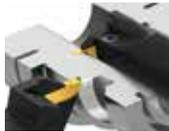
Werkzeugsystem bestehend aus zweischneidigen Hartmetall-Schneidplatten und Stahlträgerwerkzeug. Das Schneidwerkzeug, und in speziellem Maße die Schneide, ist auf optimale Spankontrolle und Leistung ausgelegt. Das spezielle Design des Plattensitzes begünstigt eine optimale Kraftaufnahme und Stabilität.
